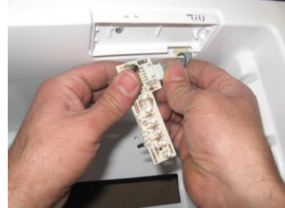
Удалить Led-плату и вытащите кабель.
